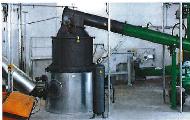
Slika 2: Reaktor za rasplinjavanje suhe drvene sječke
